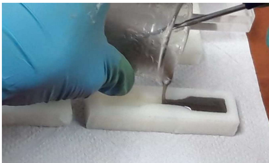
Figura 2.12. Vertido del compuesto en los moldes de silicona. [Fuente: Propia]
