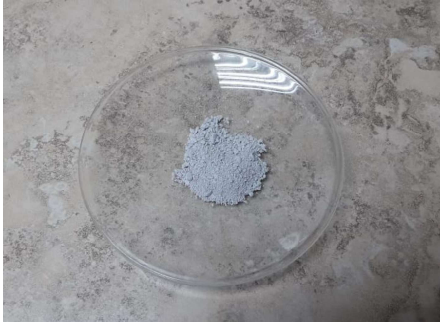
Figura 3.7. Partículas de \text{Al}_2\text{W}_3\text{O}_{12} molidas [Fuente: Propia]
