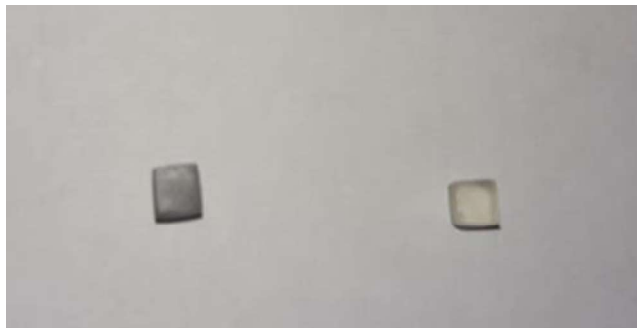
Figura 2.19. A la izquierda reposa la muestra del compuesto y a la derecha la muestra de resina epóxica pura para realizar análisis TMA.
