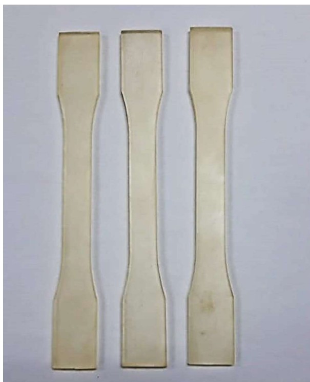
Figura 3.4. Probetas tipo I de resina epóxica pura para ensayos de tracción. [Fuente: Propia]
