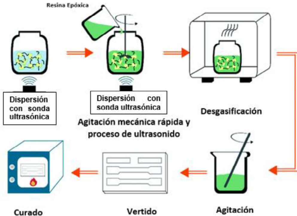
Figura 1.5. Esquema de método de “casting”. [21]
