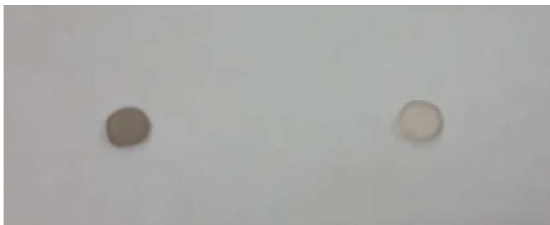
Figura 2.17. A la izquierda reposa la muestra del compuesto y a la derecha la muestra de resina epóxica pura para realizar análisis DSC y TGA.
