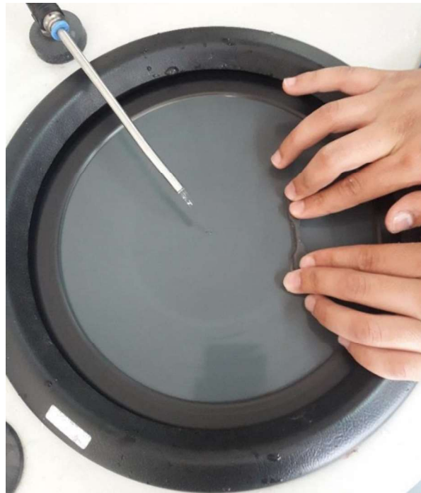
Figura 2.15. Pulido de las superficies del material compuesto. [Fuente: Propia]
