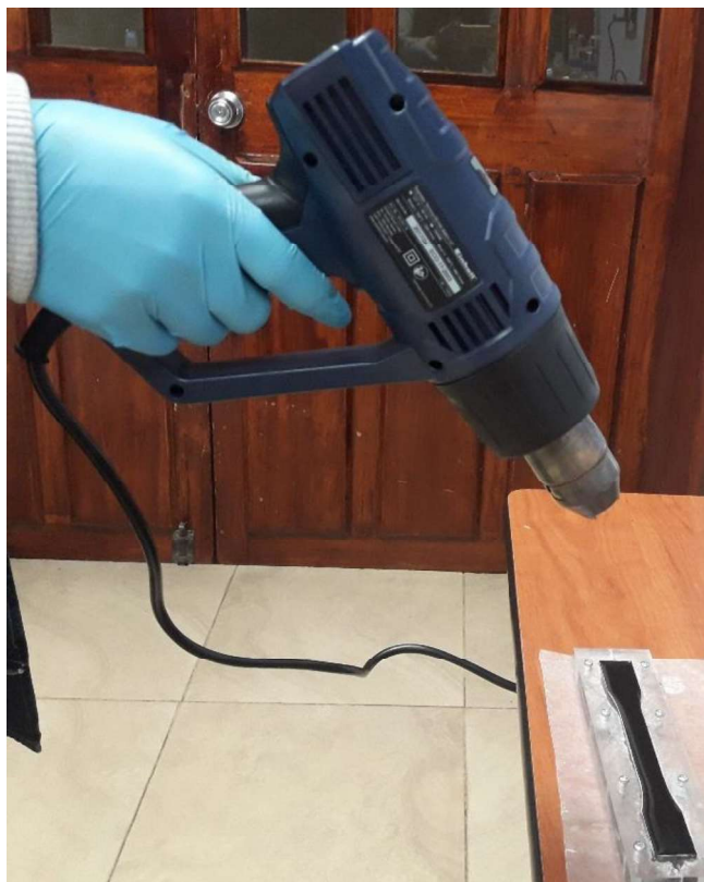
Figura 2.13. Eliminación de burbujas mediante pistola de calor. [Fuente: Propia]
