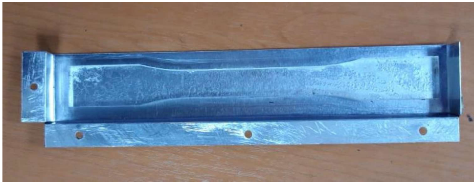
Figura 2.4. Matriz de aluminio sobre la que descansa la probeta impresa en acrílico. [Fuente: Propia]
