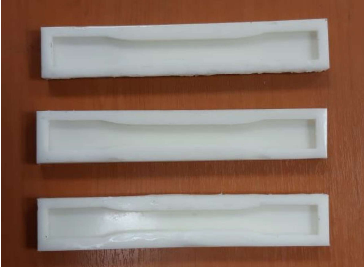
Figura 2.5. Moldes de silicona y maicena tipo I para la norma ASTM D-638-14. [Fuente: Propia]
