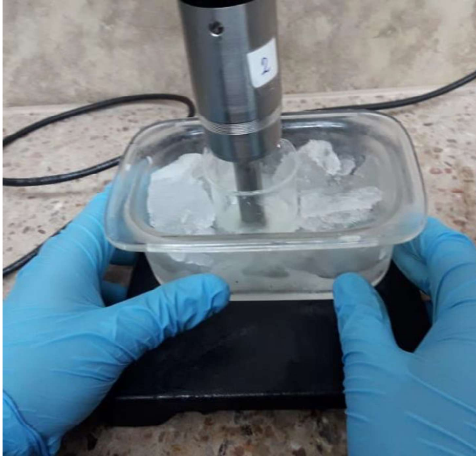
Figura 2.10. Proceso de sonicación de la mezcla en el equipo de ultrasonido con baño de hielo y sal.
