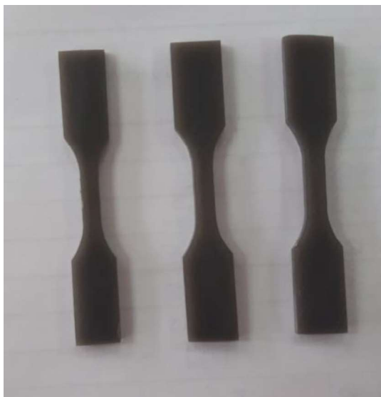
Figura 3.3. Probetas Tipo V de compuesto EP-AIW-4% para ensayos térmicos y termomecánicos. [Fuente: Propia]
