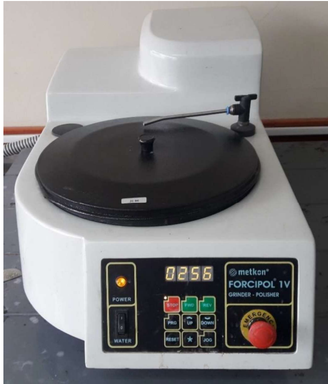
Figura 2.14. Equipo para el pulido de las superficies del material compuesto. [Fuente: Propia]
