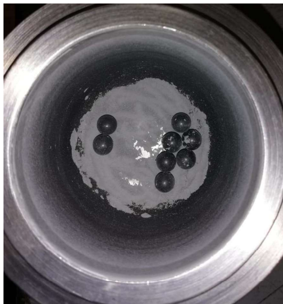
Figura 2.8. Resultado final de la molienda antes de ser retirada del equipo. [Fuente: Propia]
