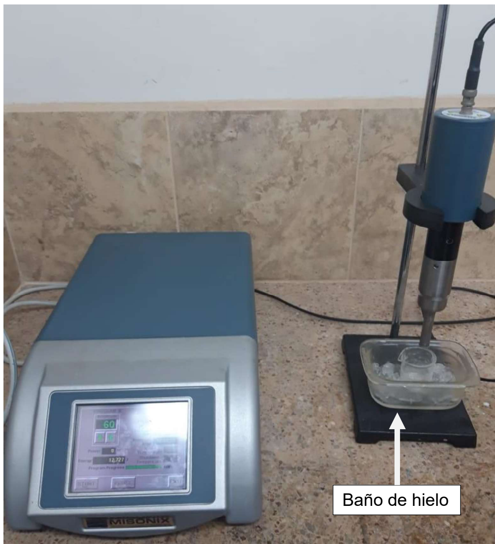
Figura 2.7. Procesador ultrasónico Misonix Sonicator 4000 Vibracell. [Fuente: Propia]
