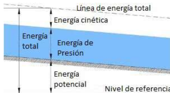
Figura 2.3 Energía total en un flujo de agua (González, et al., 2004)
