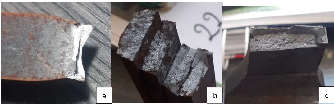
Figura 3.16. Probetas traccionadas. a) acero A36 sin tratamiento, b) acero A36 templado, c) acero A36 cementado.
