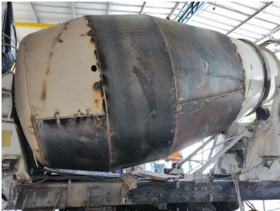
Figura 1.11. Corte de planchas para reemplazo. (Fuente: Propia)
