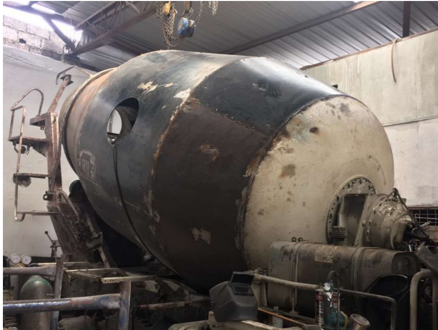
Figura 1.12. Tanque mezclador de hormigón - fabricación nacional. (Fuente: Propia)
