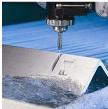
Figura 1.14. Corte de metal por chorro de agua. (Fuente: http://www.inoxidable.com/waterjet.html )
