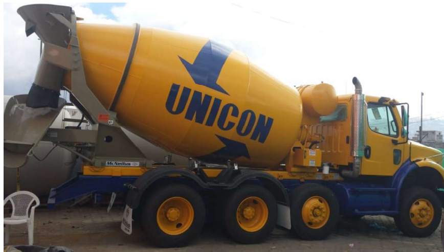
Figura 1.3. Camión mezclador de hormigón – mixer. (Fuente: Propia)
