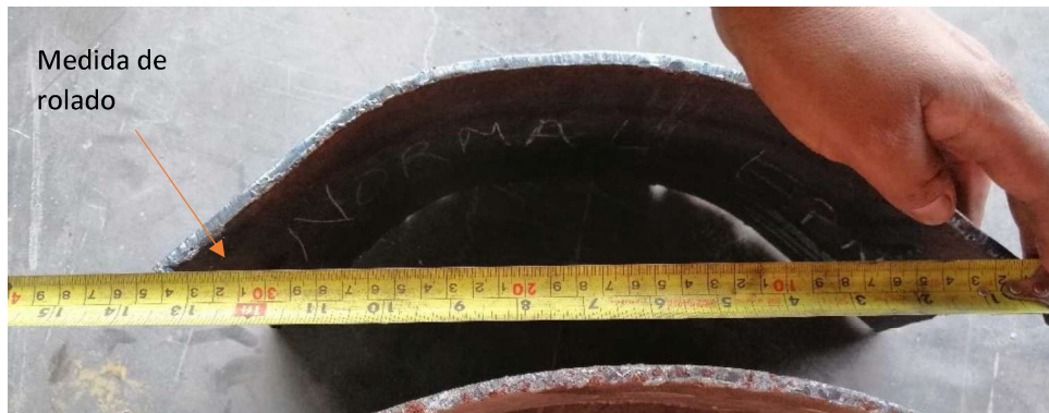
Figura 3.27. Placa de acero A36 sin tratamiento.
