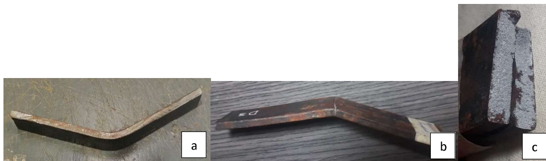
Figura 3.12. Probetas flexionadas. a) acero A36 sin tratamiento, b) acero A36 templado, c) acero A36 cementado.
