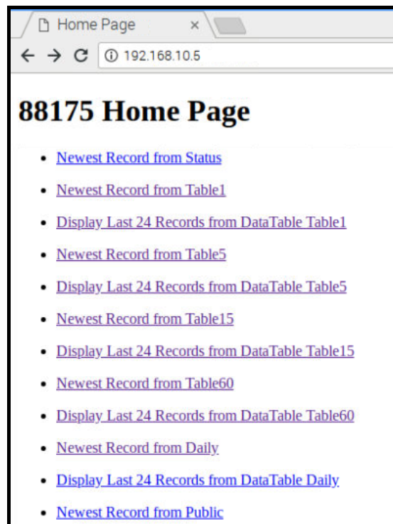
Figura 2.37. Interfaz web Datalogger CR1000
