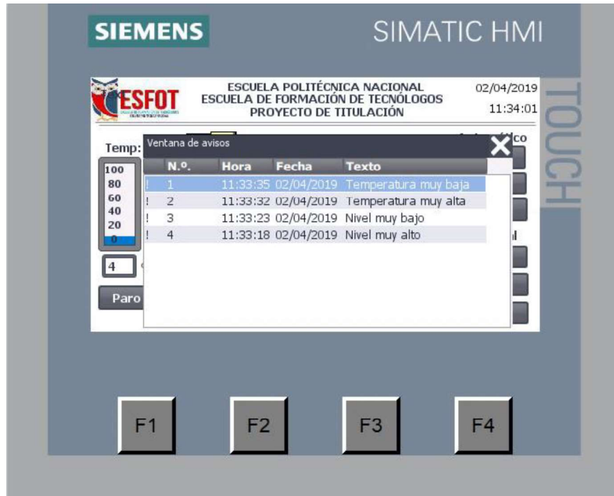
Figura 3.58. Ventana: De avisos del Panel HMI.
