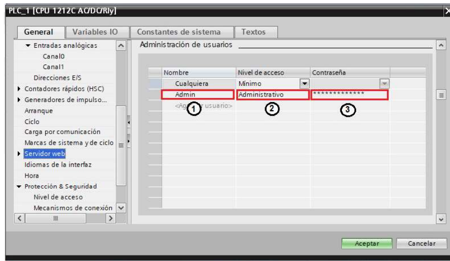
Figura 3.14. Ajustes en la administración de usuarios para el servidor web del PLC.
