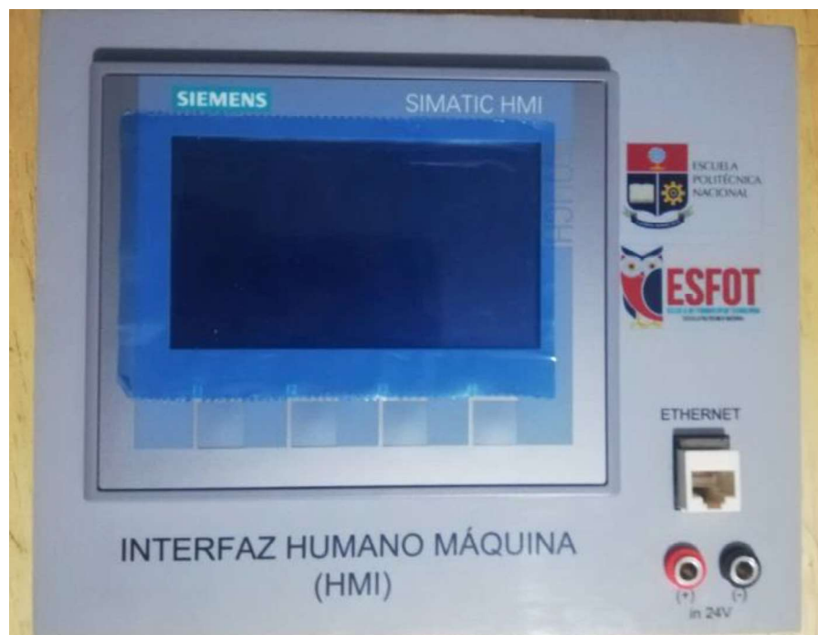
Figura 3.44. Placa móvil terminada del Panel HMI.
