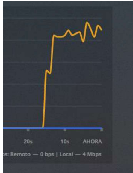
Figura 3.59 Estadísticas del ancho de banda consumido al reproducir contenido multimedia en calidad 720p en el dispositivo 5.
