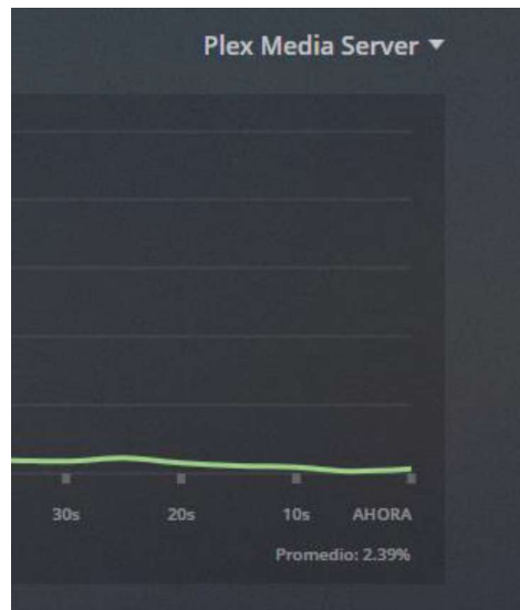
Figura 3.48 Estadísticas del uso del CPU del servidor al reproducir contenido multimedia en calidad 1080p en el dispositivo 1.
