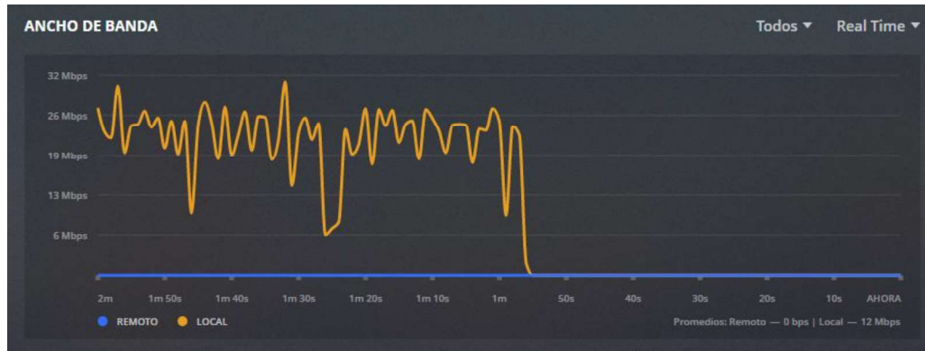
Figura 3.36 Estadísticas del uso de ancho de banda de la red al tener “dos dispositivos simultáneos”.
