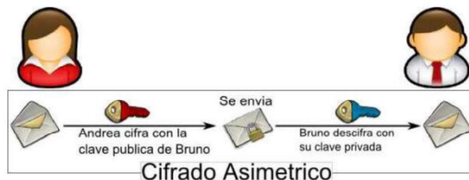
Figura 1.9. Mecanismo del cifrado asimétrico [7]
