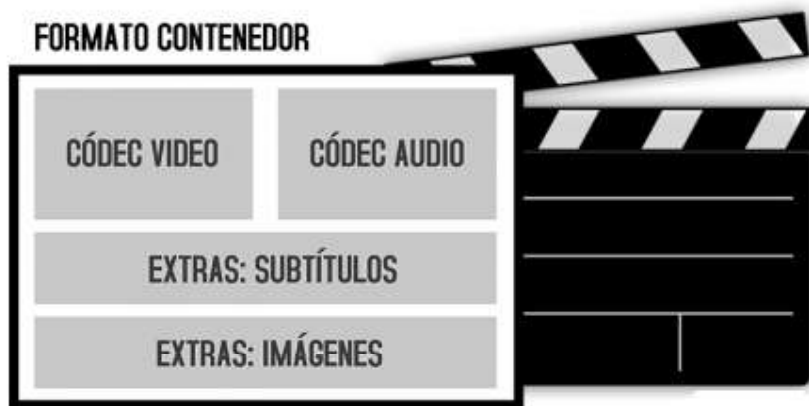
Figura 6.15. Contenedor y sus componentes [56].
