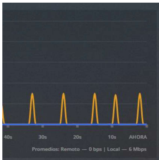
Figura 3.53 Estadísticas del ancho de banda consumido al reproducir contenido multimedia en calidad 1080p en el dispositivo 4.
