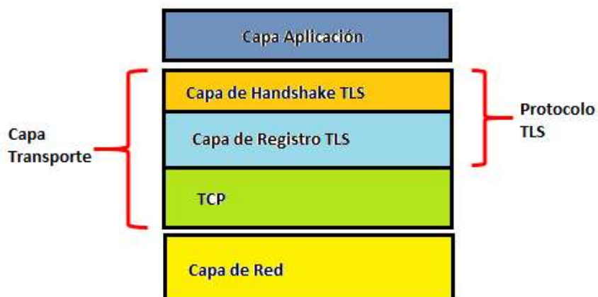
Figura 1.10. Parte del modelo TCP/IP y la ubicación del protocolo TLS
