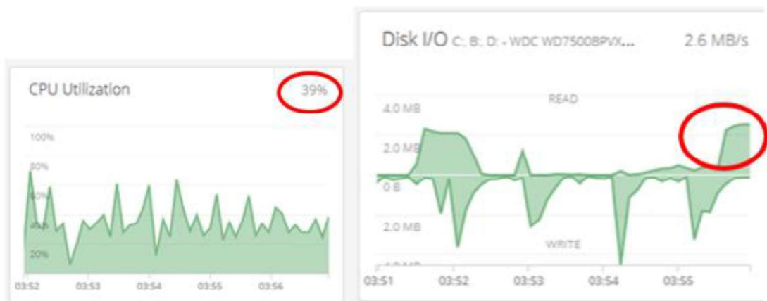
Figura 3.24. Ocupación de los recursos del servidor cuando se tiene dos usuarios.
