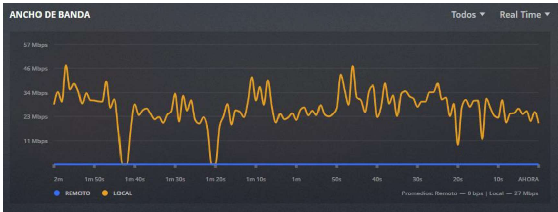
Figura 3.38 Estadísticas del uso de ancho de banda de la red al tener “cinco dispositivos simultáneos”.
