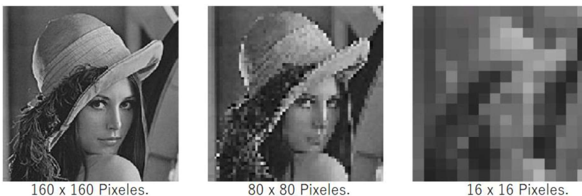
Figura 1.23. Diferentes pixelados en una imagen [11].
