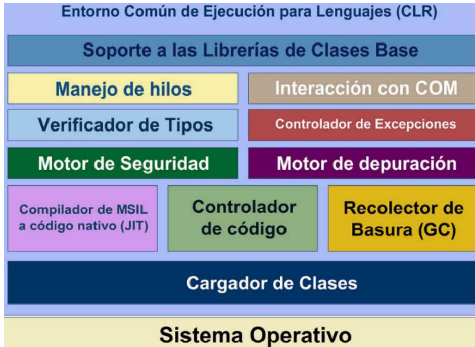
Figura 1.6. Entorno común de ejecución para lenguajes [32].
