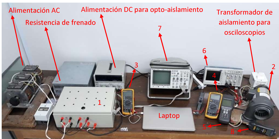
Figura 3.27. Electrónica de potencia, carga e instrumentación empleada en la validación de la modulación SPWM configurada en ZYBO
