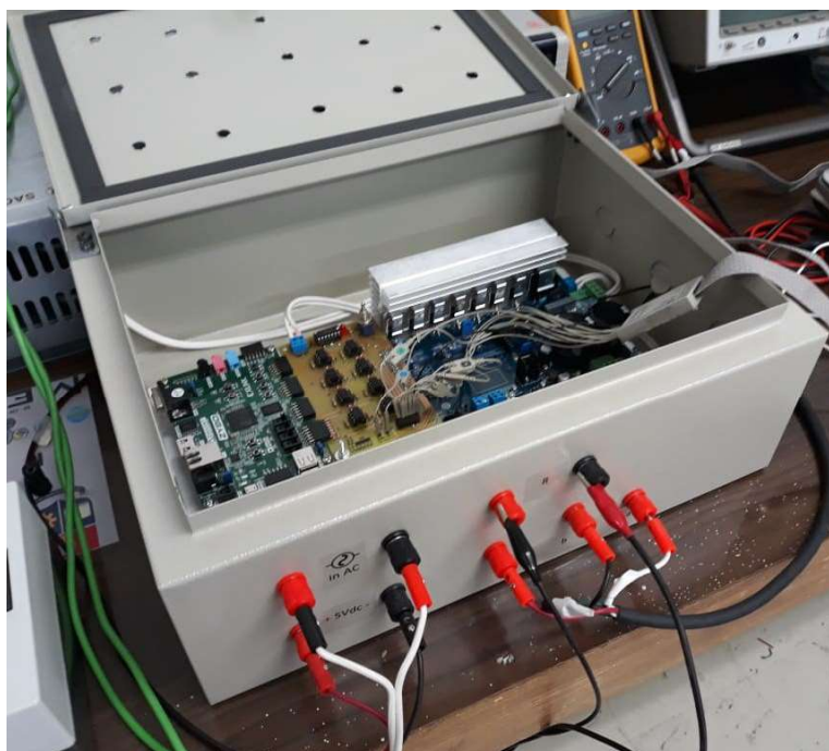
Figura 3.22. Estructura metálica que contiene al sistema ZYBO-opto acoplamiento-inversor trifásico
