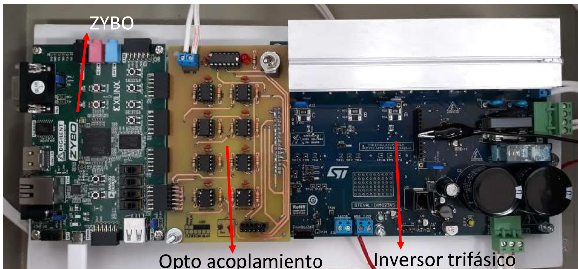
Figura 3.21. Sistema ZYBO-opto acoplamiento-inversor trifásico STEVAL-IHM023V3
