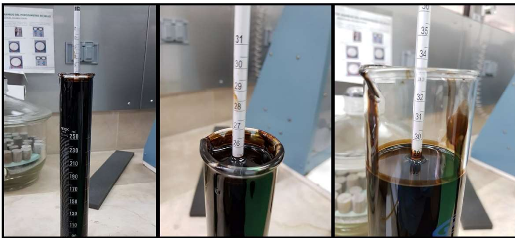
Figura 14: Determinación de °API mediante hidrómetro (izquierda y centro crudo SSF 79, derecha crudo SSF 74)
