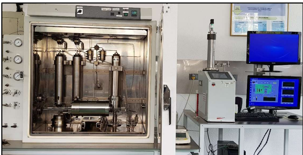
Figura 9: Equipo FDS 350, compuesto por: 3 acumuladores, líneas de inyección de fluidos, y un coreholder
