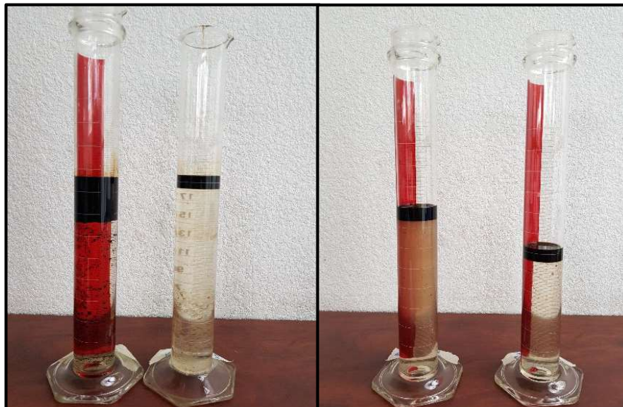
Figura 17: Hidrocarburo recuperado mediante desplazamiento con agua y nanofluido
