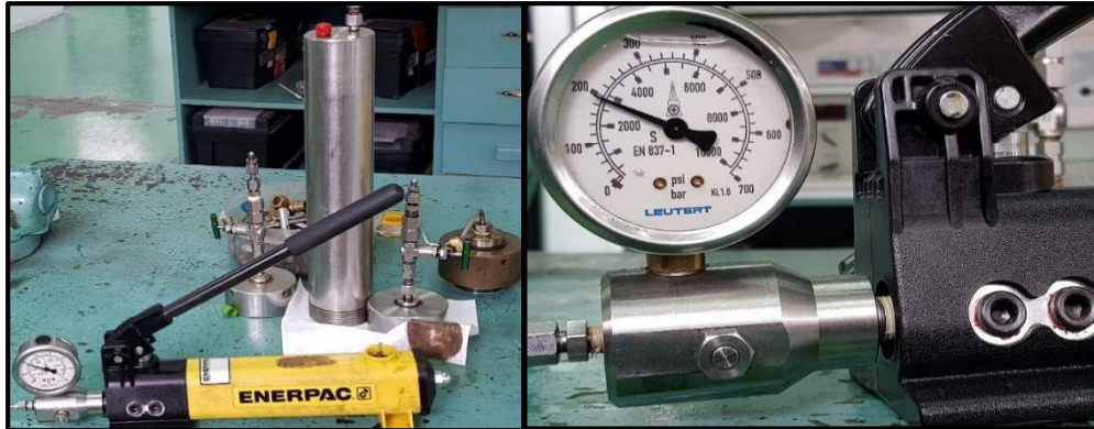
Manómetro con 3000 psi saturando plug con agua de formación.
