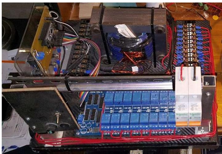
**Figura 3.3.** Equipo simulador de fluctuaciones de voltaje de corta duración.
