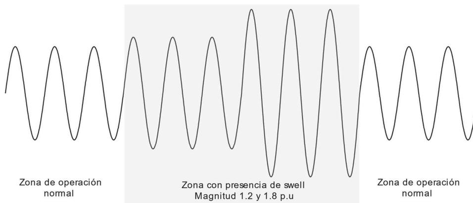
**Figura 1.9.** Presencia de un swell en la red eléctrica.
