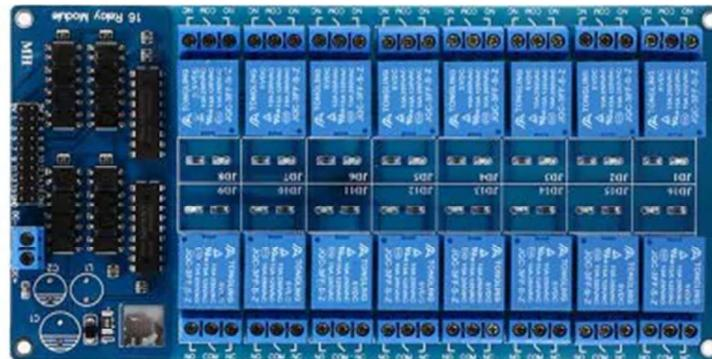
**Figura 2.20.** Modulo 16 relés, 5V – opto aislados.
