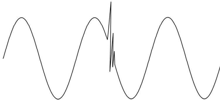
**Figura 1.6.** Transitorio oscilatorio ocasionado por la conmutación de capacitores.
