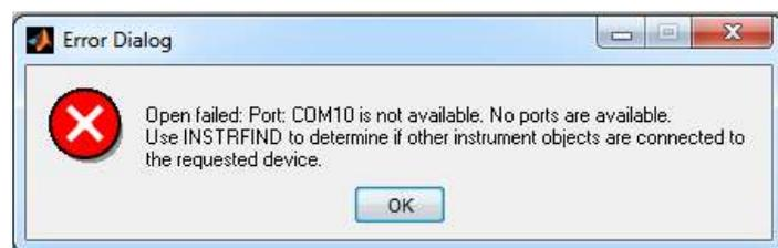
**Figura 2.36.** Mensaje de error por falla al abrir el puerto y establecer la comunicación serial
