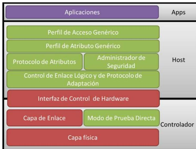
**Figura 1.15.** Pila de protocolos BLE [33].
