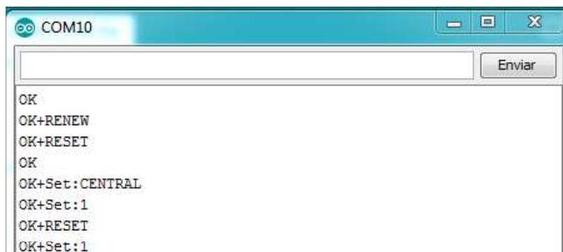
**Figura 2.3.** Comandos AT módulo HM-10 (Monitor serial Arduino IDE)
