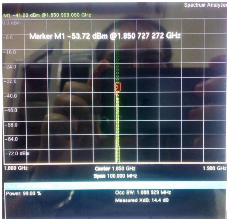
**Figura D4.** Ancho de Banda y potencia para Tuenti.
