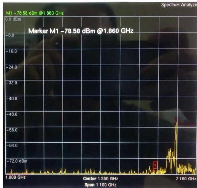
**Figura D1.** Espectro de frecuencias para LTE
