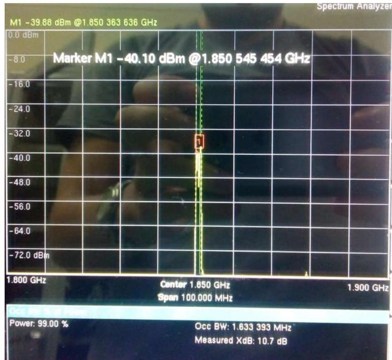
**Figura D3.** Ancho de Banda y potencia para Movistar.
