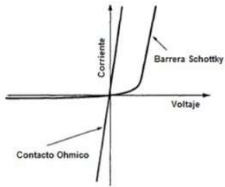
Figura 1.19. Curvas características V vs I de contacto metal – semiconductor. (Fuente: [22])
