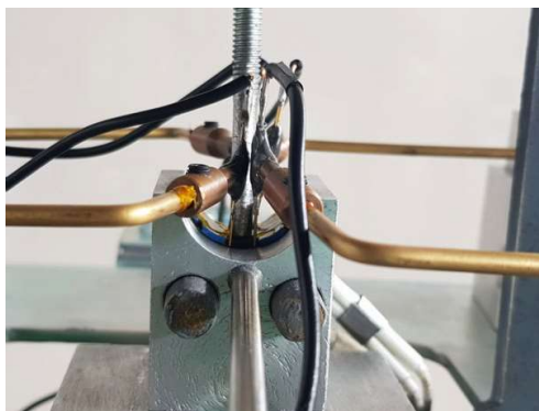
Figura 2.60. Medición del voltaje a 5 [mm] del centro de la muestra sometido a un radio de curvatura.
