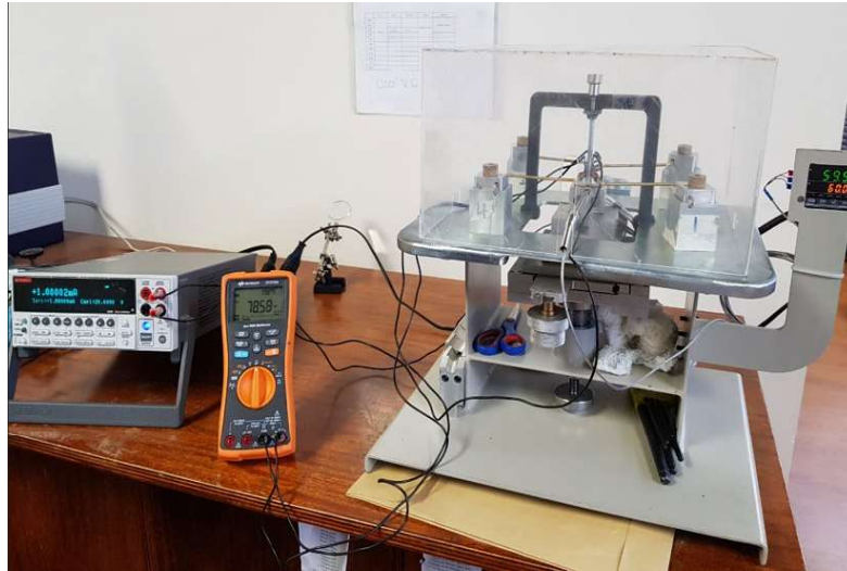
Figura 2.57. Máquina para ensayar un material termoeléctrico de película delgada por el método de Van der Pawn.
