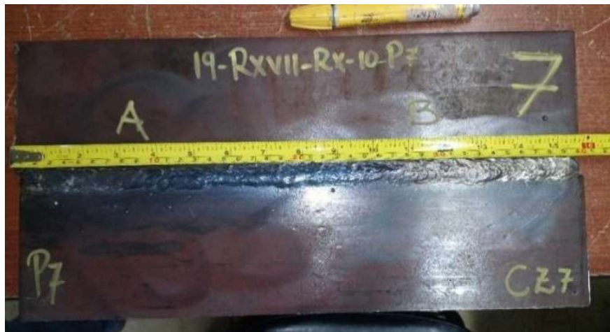
Figura 2.3. Espécimen de soldadura siendo medido para la preparación del ensayo de radiografía.
