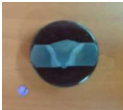
Figura 2.9. Probeta lista para realizar el ensayo de metalografía.
