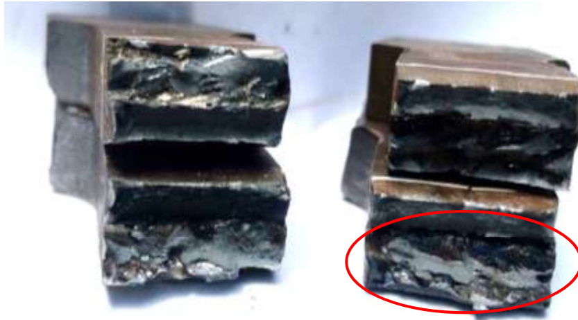
Figura 3.19: Superficie de fractura de la probeta P1, se puede observar la falta de fusión presente en la zona de soldadura de la probeta y además se evidencia la fractura frágil ya que la sección reducida fallo sin haberse deformado.
