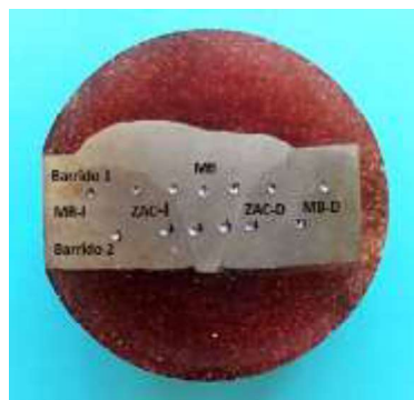
Figura 3.13. Probeta utilizada para medición de dureza.
