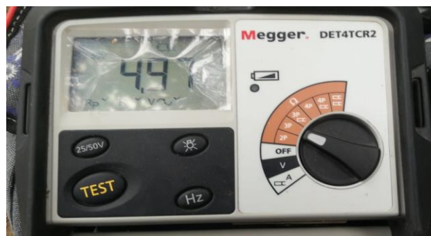
Figura 3.42: Lectura de medición de resistencia a tierra edificio dirección ESFOT. Fuente: (Propia)
