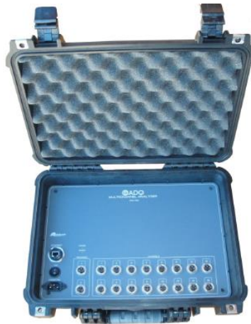
Figura 1.10. Equipo de adquisición de señales dinámicas del LAEV. (Fuente: IDM, 2019)
