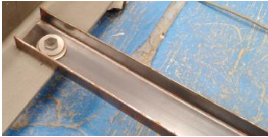
Figura 2.4. Sujeción de los extremos de la viga mediante pernos. (Fuente: Propia)
