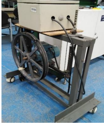
Figura 2.3. Fuente de excitación de la viga. (Fuente: Propia)
