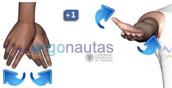
Figura 1.24. Ajustes por desviación radial/cubital o torsión considerados para la evaluación de muñeca con REBA. (Fuente: [54])
