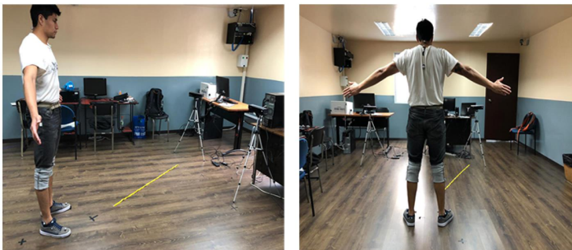
Figura 2.5. Posicionamiento de los sensores y verificación de detección de marcadores. (Fuente: Propia)
