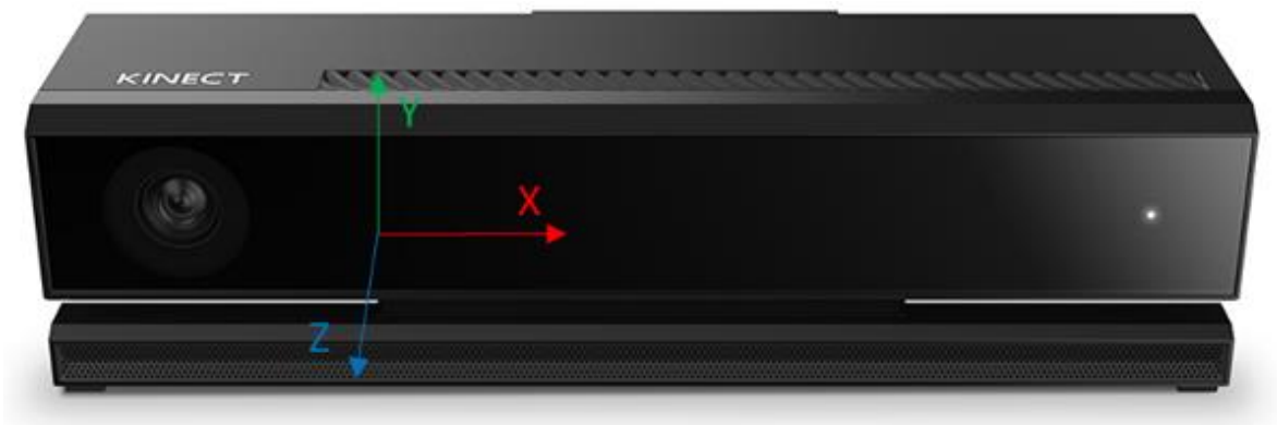
Figura 1.7. Coordenadas en el espacio del sensor Kinect v2. (Fuente: [44])
