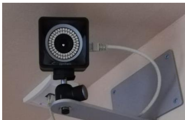
Figura 1.9. Cámara Infrarroja del sistema Kinescan/IBV. (Fuente: Propia)
