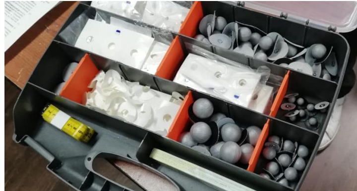
Figura 1.10. Marcadores del sistema Kinescan/IBV. (Fuente: Propia)
