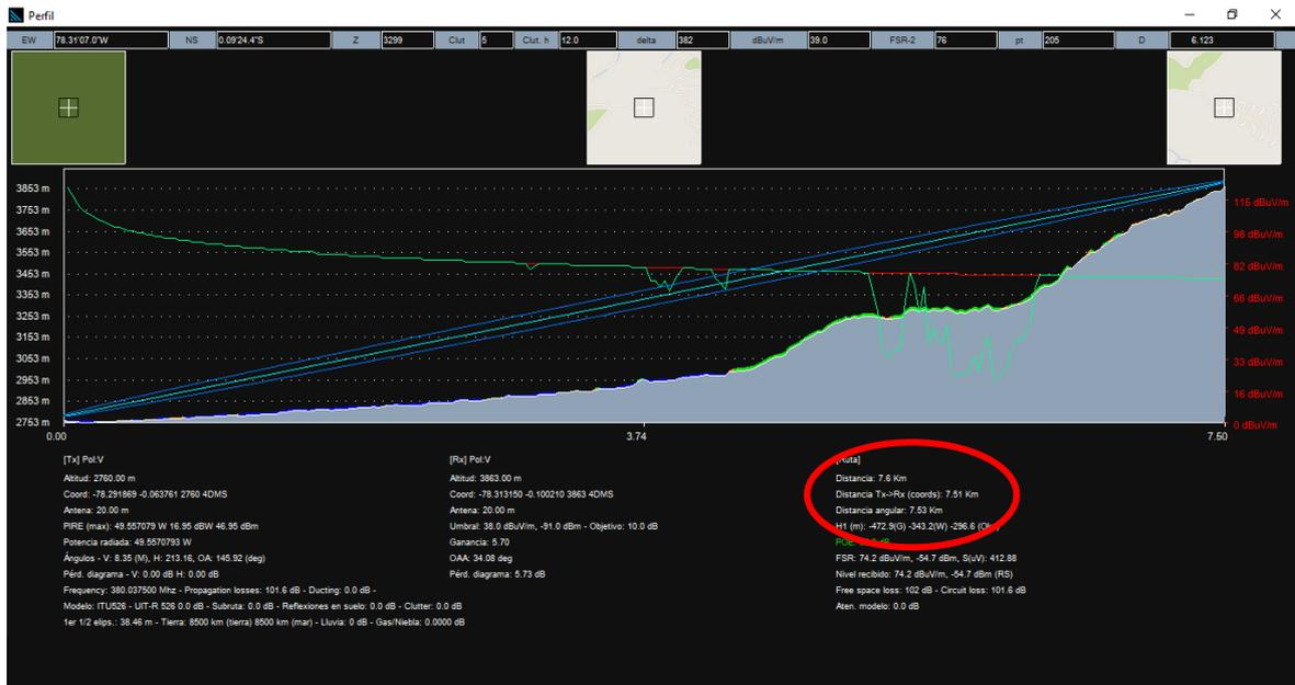
**Figura 2.4.** Perfil que muestra la distancia entre usuario más alejado con su correspondiente estación base.
