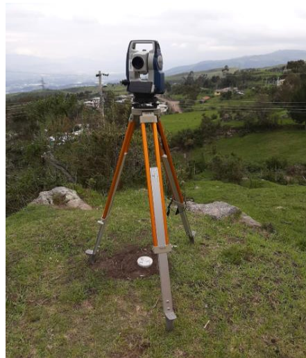
Figura 31. Estación total ubicada en el primer punto
