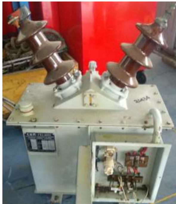
Figura 3.7. Transformador combinado de medida monofásico ensayado [Elaboración propia].
