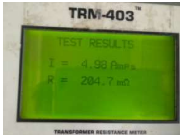
Figura 3.9. Resultados de la medición de la resistencia de bobinados en la bobina C – L del lado de baja del TC [Elaboración Propia].
