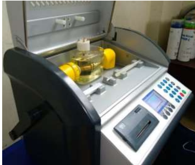
Figura 3.5. Probador de aceite con el líquido a ensayar en la copa [Elaboración propia].
