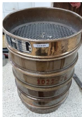
Figura 34. Ensayo para obtener granulometría.
