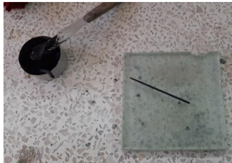
Figura 33. Ensayo límite plástico.
