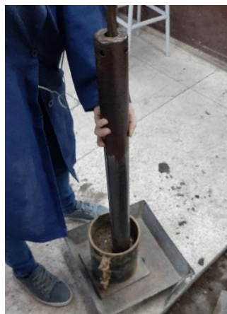
Figura 36. Compactación de la muestra usando martillo manual.
