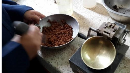
Figura 32. Ensayo límite líquido por el método de Casa Grande.
