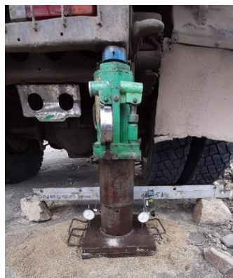
Figura 38. Ensayo de Placa o C.B.R. de campo.
