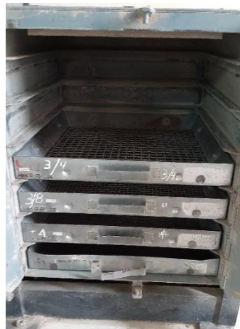
Figura 35. Tamizado para determinar el método de ensayo proctor.
