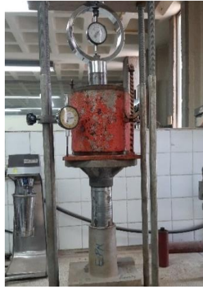
Figura 37. Ensayo California C.B.R.
