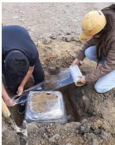
Figura 31. Toma de muestra inalterada de suelo en la vía de estudio.
