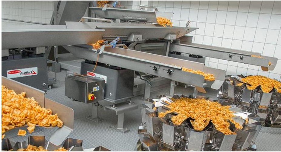
Figura 2.27 Esquema de los alimentadores en la plataforma de empaque (Fuente: (HEAT AND CONTROL, 2020)
