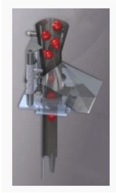
Figura 1.4 Flujo de producto dentro del tubo de formado (Fuente: (Dennis, Greener corporation Soluciones P3TM, 2018))
