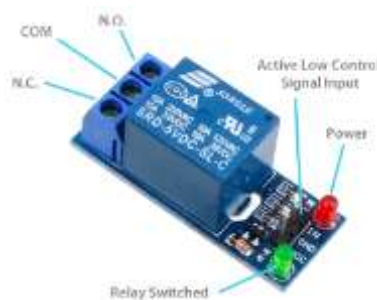
Figura 2.19 Módulo relé de un canal.
