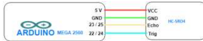
Figura 2.27 Conexión Arduino Mega 2560 y módulo HC-SR04
