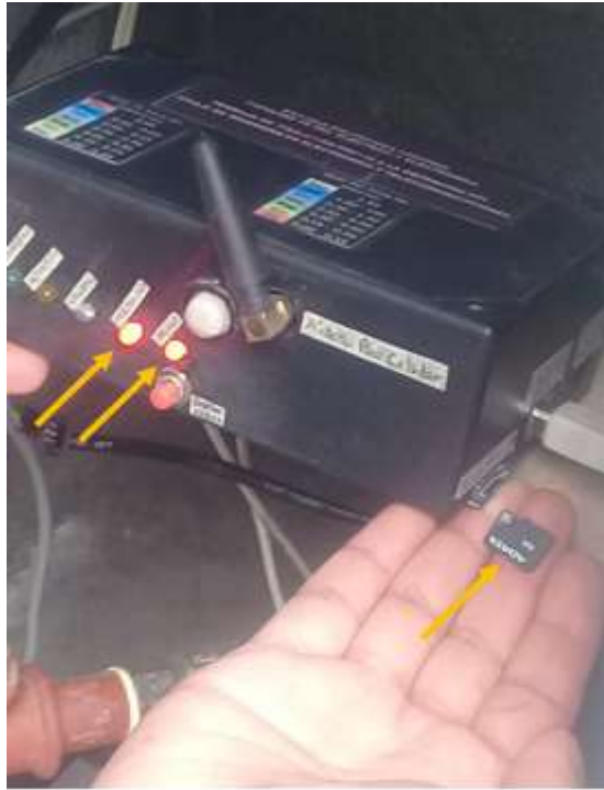
Figura 3.2 Inicialización del sistema sin tarjeta micro_SD
