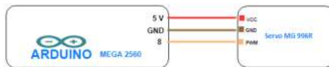
Figura 2.23 Conexión Arduino Mega 2560 y Servo MG 996R
