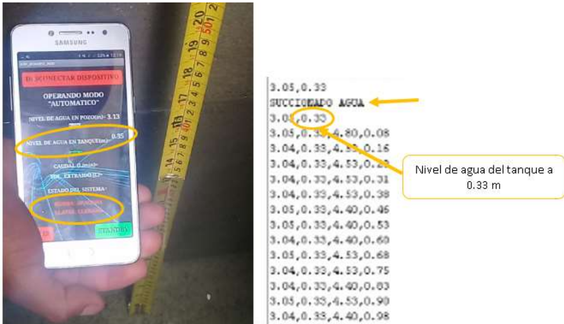
Figura 3.12 Nivel límite de agua en el tanque para proceso de succión.
