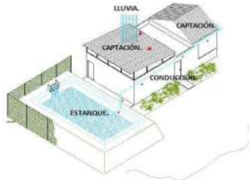
Figura 1.6 Captación de aguas lluvias [12]
