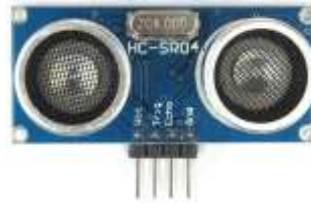
Figura 2.25 Sensor ultrasónico HC-SR04
