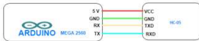
Figura 2.14 Conexión Arduino Mega 2560 y módulo HC-05
