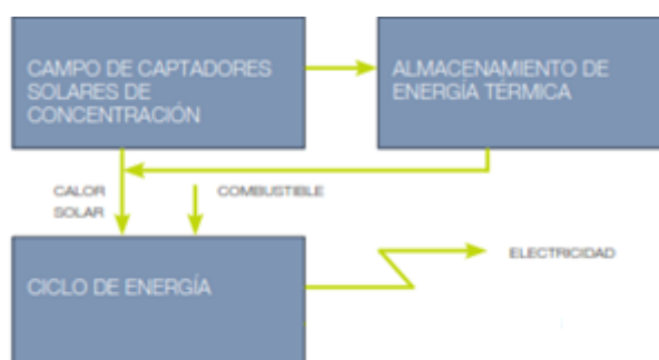
Figura 6. Esquema de planta de concentración solar. (Fuente: (Richter, 2009))
