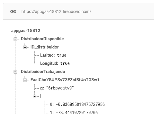
Figura 3.14 Actualización de la base de datos de Firebase cuando un distribuidor recibe un pedido
