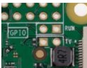
**Figura 1.4.** Pines adicionales para encendido o reset y para transmisión de video compuesto [7].
