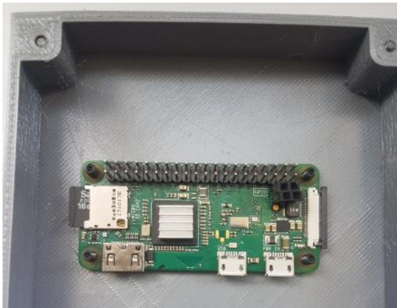
**Figura 2.9.** Colocación y ajuste de Raspberry Pi en carcasa.
