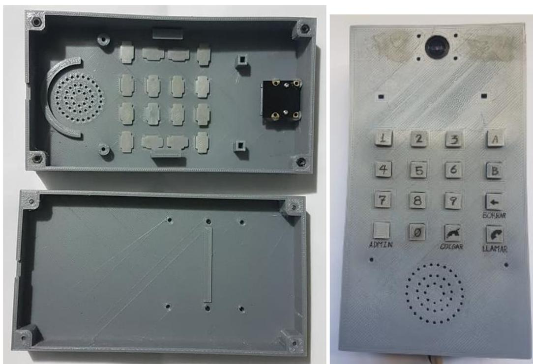
**Figura 2.8.** Carcasa construida para el ensamblaje del Video Portero.
