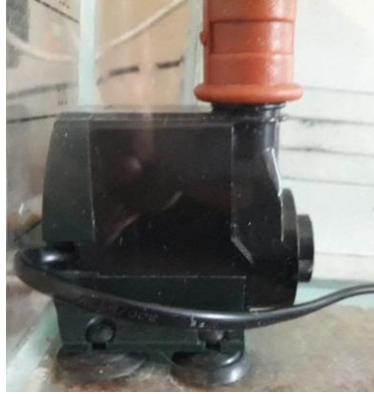
Figura 3.9 Bomba eléctrica sumergible.
