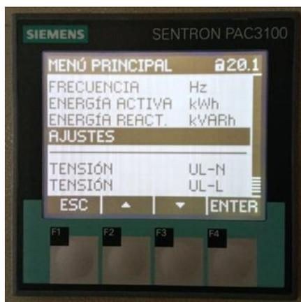
**Figura 3.10** Medidor multifunción SENTRON PAC3100.
