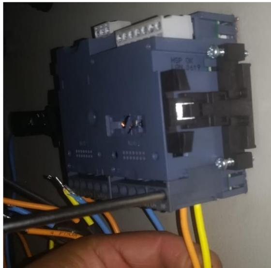
**Figura 3.35** Conexión del voltaje de alimentación.
