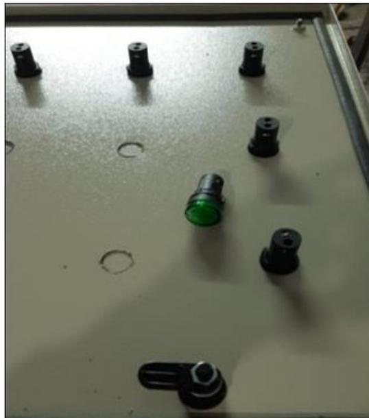
**Figura 3.14** Toma de medidas para ubicar las luces piloto.
