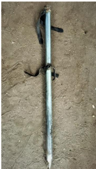
Figura 3.36 Estaca de fijación para aspersor (Fuente Propia)
