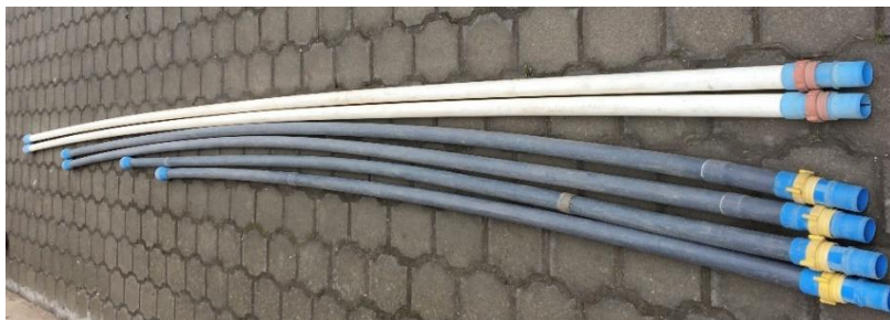
Figura 3.34 Tubos de PVC con puntas móviles (Fuente Propia)
