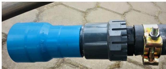
Figura 3.33 Conexión de punta hembra en manguera (Fuente Propia)
