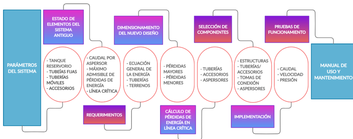
Figura 2.1 Esquema de la metodología usada en el proyecto. (Fuente Propia)
