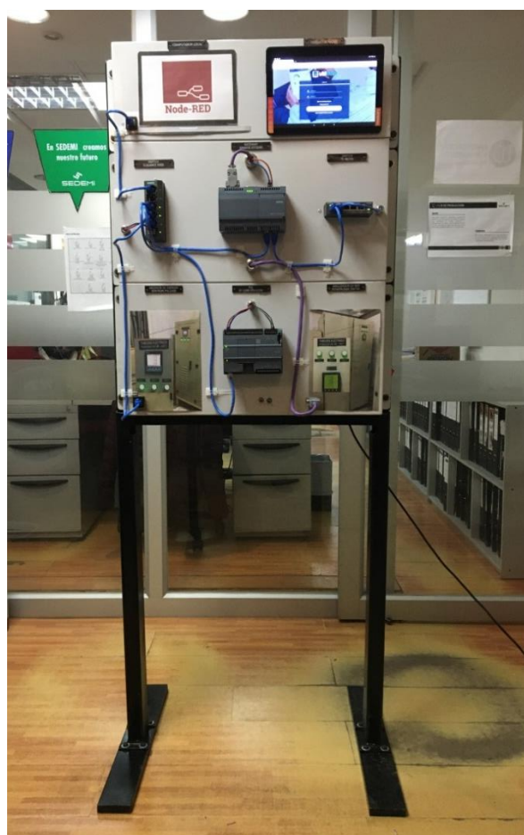
Figura 2.170. Tablero de control didáctico terminado
