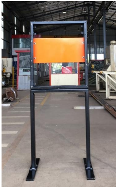
Figura 2.161. Tablero de control didáctico pintado
