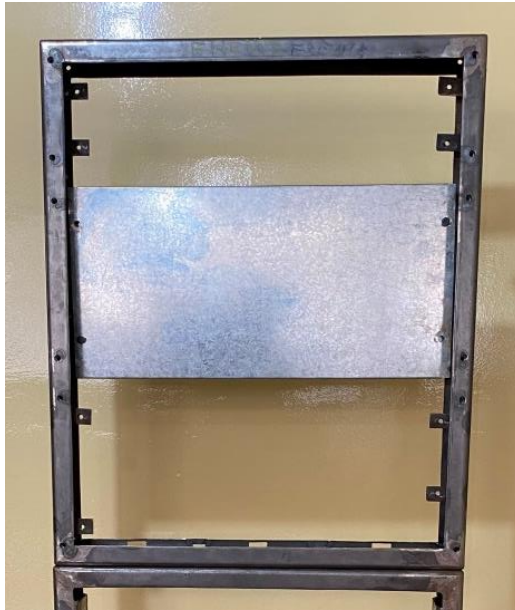
Figura 2.159. Perfil de soporte de la parte interna
