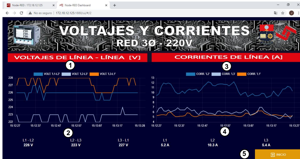
Figura 3.4 Página voltajes y corrientes de la red 3Ø de 220V
