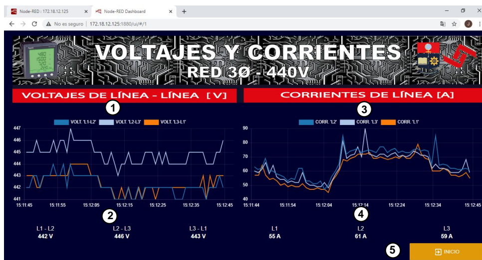
Figura 3.3 Página voltajes y corrientes de la red 3Ø de 440V
