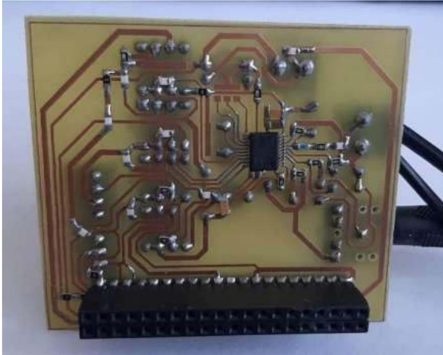
**Figura 2.6** Imagen Inferior del Medidor de Energía Implementado
