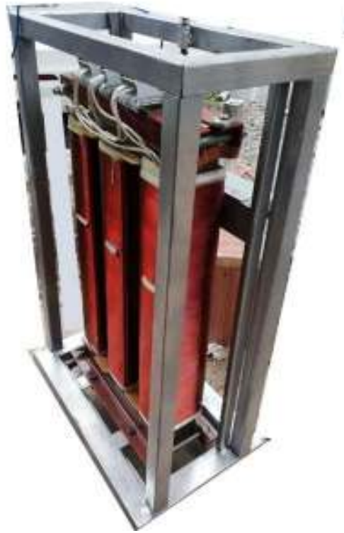
Figura 3.16 Autotransformador en la estructura metálica
