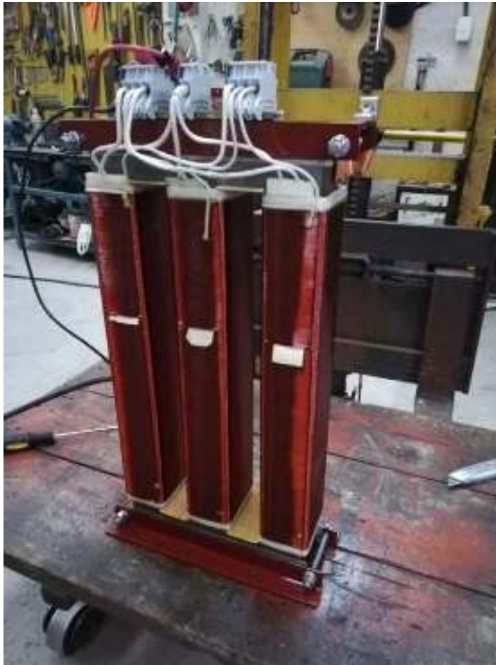
Figura 3.14 Cableado y montaje de borneras
