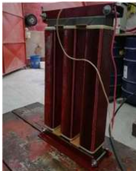
Figura 3.13 Autotransformador trifásico construido
