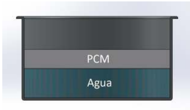
Figura 2.10 - Configuración experimental 1:1/2 con 1kg de agua y 0.5 kg de PCM.
