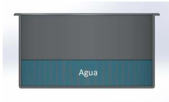
Figura 2.13 - Configuración experimental 1:0 con 1kg de agua y 0 kg de PCM.
