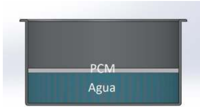
Figura 2.12 - Configuración experimental 1:1/8 con 1kg de agua y 0.125 kg de PCM.
