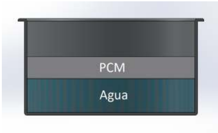
Figura 2.7 - Configuración de mezcla agua + PCM (parafina)
