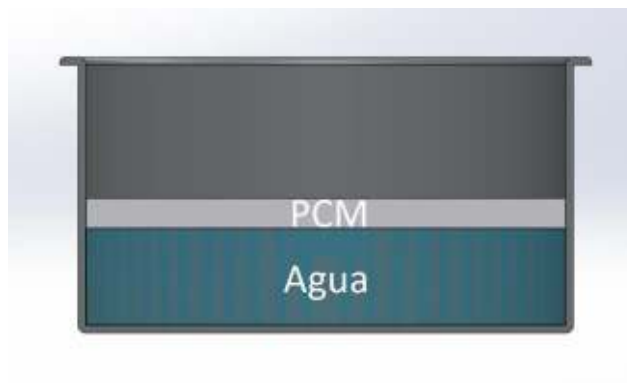
Figura 2.11 - Configuración experimental 1:1/4 con 1kg de agua y 0.25 kg de PCM.
