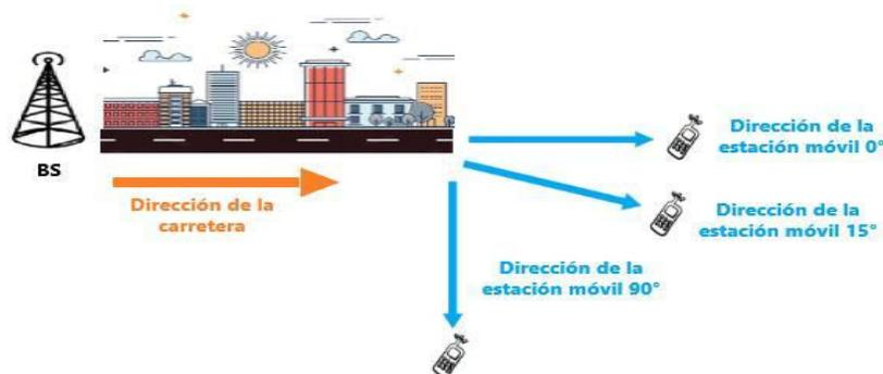
**Figura 3.8.** Diagrama del ángulo agudo entre la dirección de la estación móvil y la dirección de la carretera para un entorno sin línea de vista.
