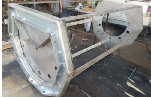
Figura 2.58. Construcción del bastidor superior (Fuente: Propia)
