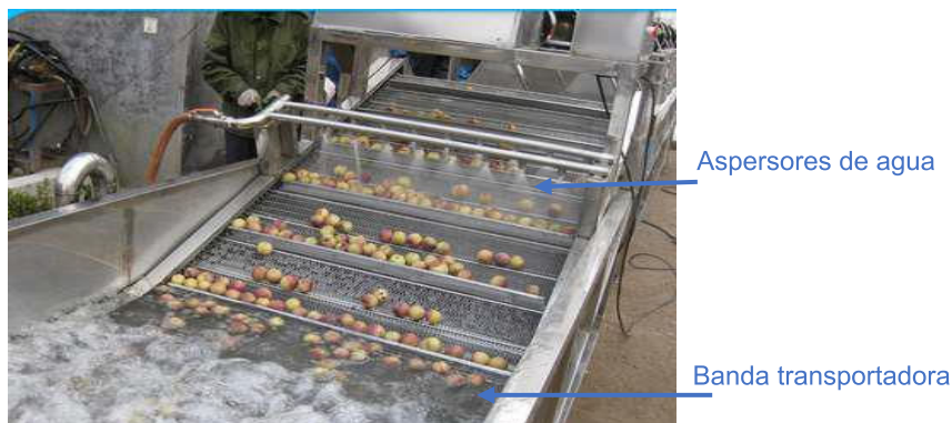
Figura 1.6. Máquina desespinaadora con bandas transportadora y agua. (Fuente: Infoagro,2018)
