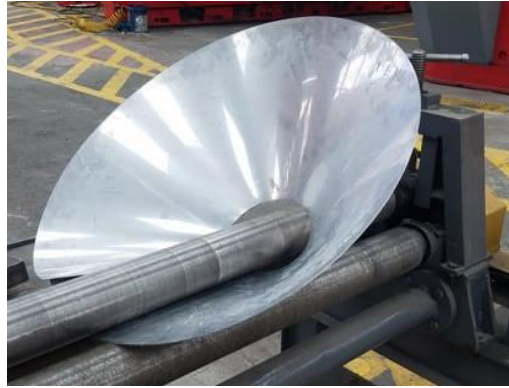
Figura 2.63. Construcción de dosificadora (Fuente: Propia)
