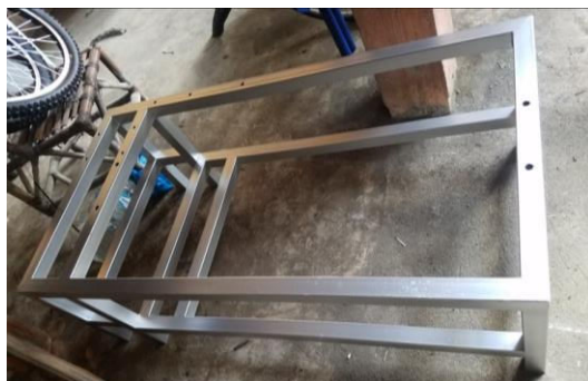
Figura 2.57. Construcción del bastidor inferior (Fuente: Propia)
