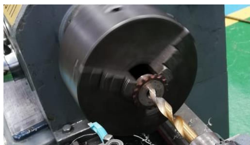
Figura 2.6. Maquinado de piñones y poleas (Fuente: Propia)
