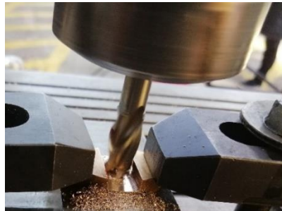
Figura 2.18. Ranurado central presente en las contrapesas. [Fuente propia]
