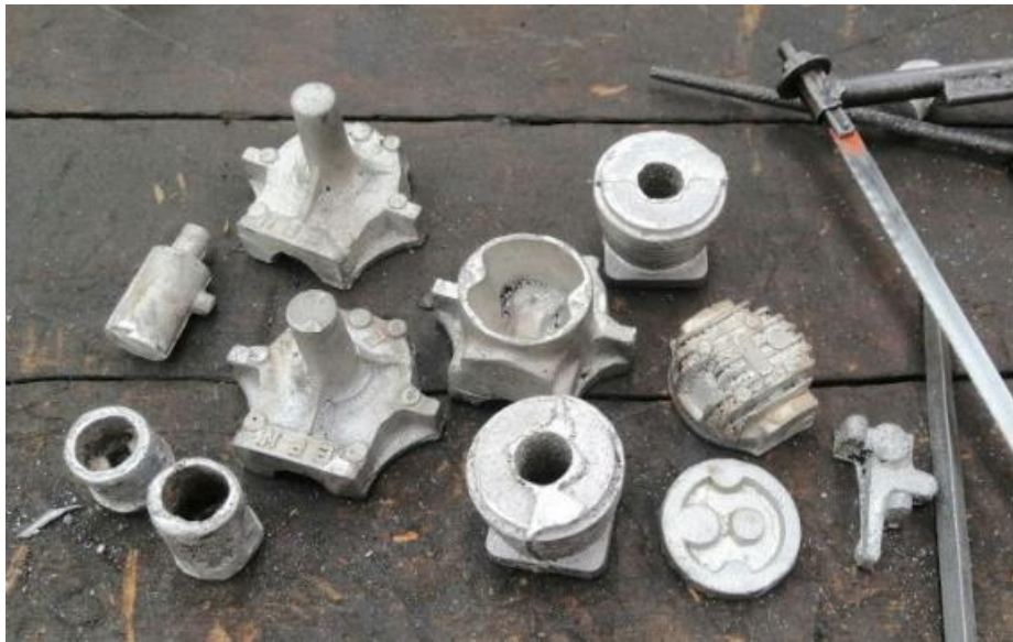
Figura 2.15. Partes del prototipo de motor de combustión interna, en aluminio A356. [Fuente propia]
