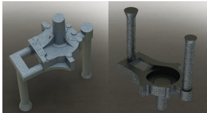
Figura 2.9. Diseño de mazarota, para simulación del comportamiento del flujo del colado, renderizado en SolidWorks. [Fuente propia]
