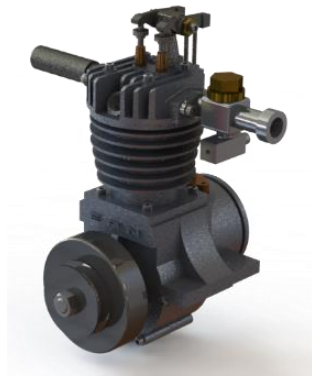
Figura 2.23. Prototipo de motor de combustión interna ensamblado, vista isométrica, renderizado en SolidWorks. [Fuente propia]
