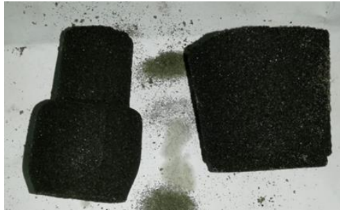
Figura 2.13. Forma y textura de macho elaborado. [Fuente propia]
