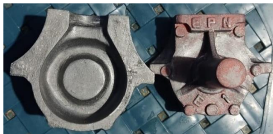
Figura 2.8. Modelo de cárter impreso y corregido. [Fuente propia]
