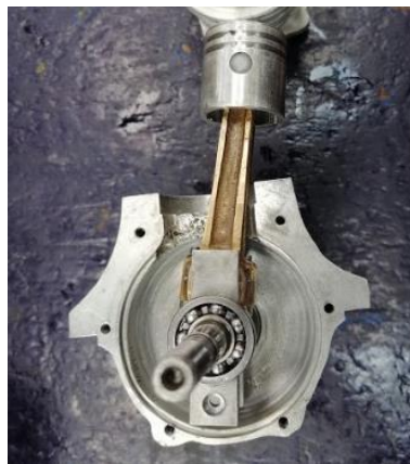
Figura 2.25. Montaje del cigüeñal en el cárter, prueba de ajustes y tolerancias. [Fuente propia]
