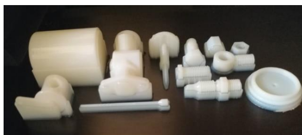
Figura 1.6. Elementos de un carburador por fabricación aditiva Polyjet. [Fuente propia]
