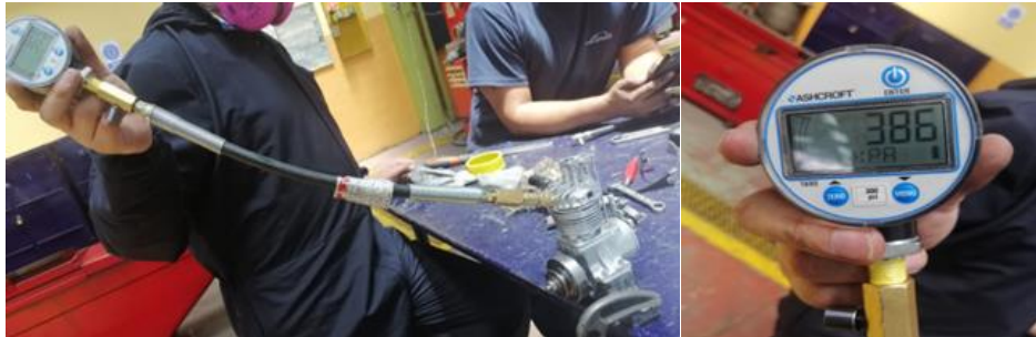
Figura 2.38. Resultados de la compresión. [Fuente propia]
