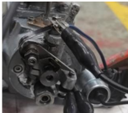
Figura 1.3. Sistema de encendido clásico con adaptación de ruptor para el prototipo. [Fuente propia]
