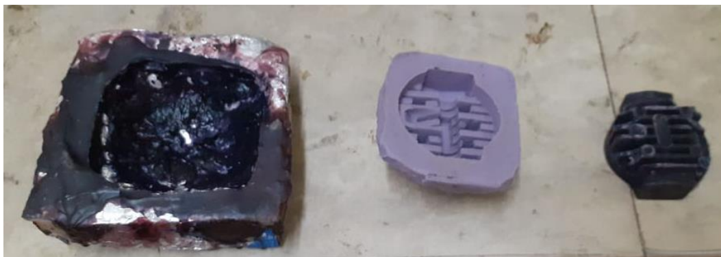
Figura 2.14. Molde plástico y en cera elaborados. [Fuente propia]
