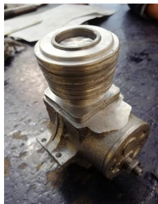
Figura 2.27. Montaje del bloque del prototipo de motor de combustión interna. [Fuente propia]
