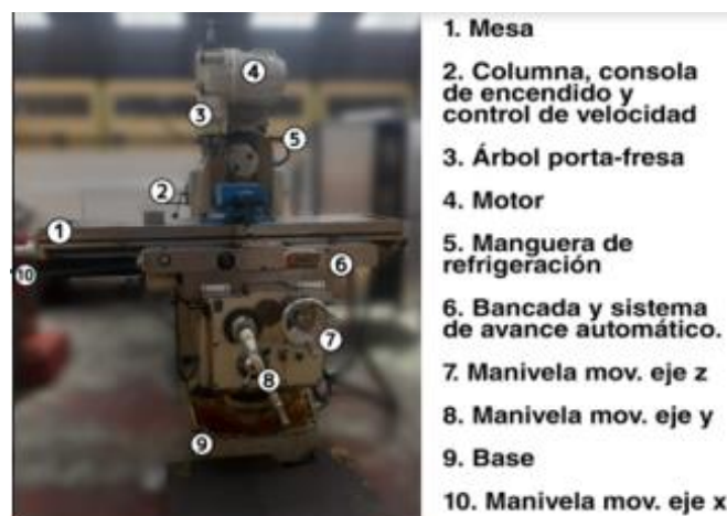
Figura 2.5. Fresadora y sus partes. [Fuente propia]
