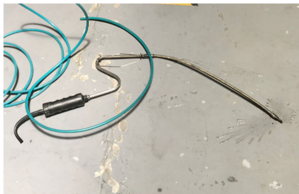
Figura 2.3 Sonda de gases de combustión. (Fuente: Propia)
