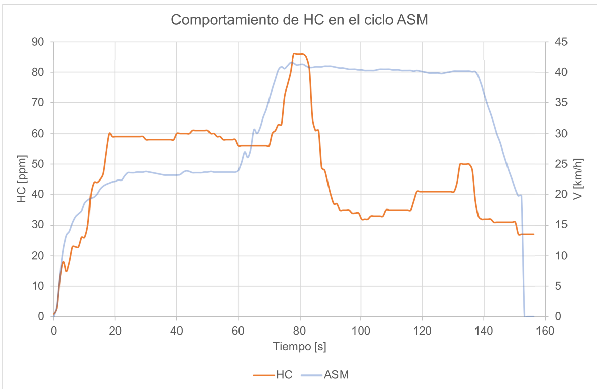
Figura A15. Comportamiento del HC en el ciclo ASM (prueba 5).
