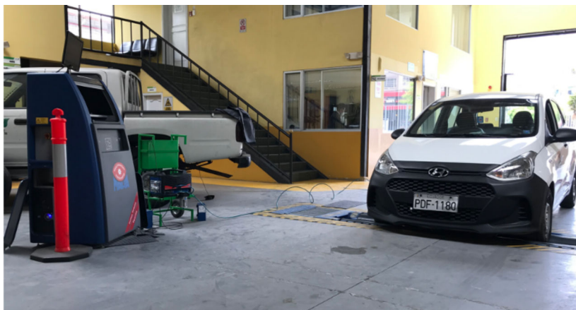
Figura 2.12 Ruedas motrices centradas sobre dinamómetro.
