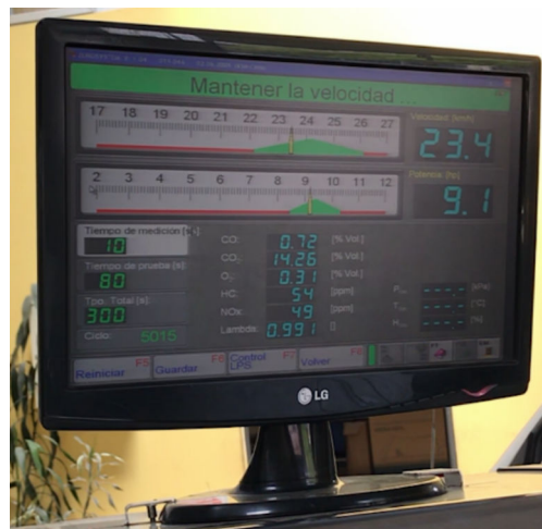
Figura 2.14 Fase de medición ASM 5015. (Fuente: propia)
