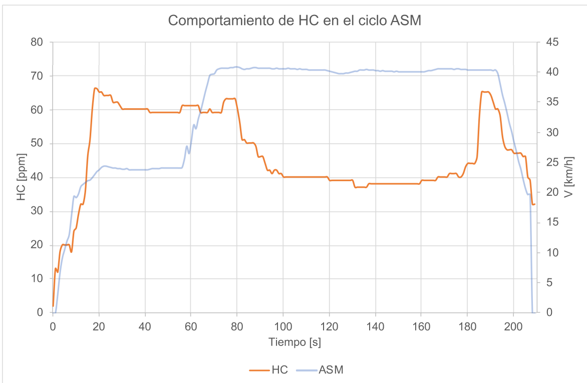
Figura A7. Comportamiento del HC en el ciclo ASM (prueba3).
