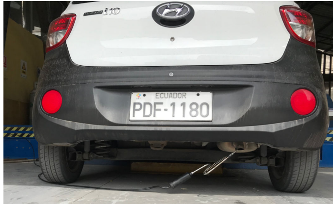
Figura 2.21 Instalación de sonda de gases. (Fuente: propia)
