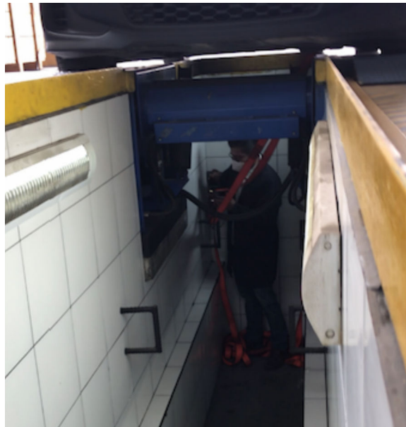
Figura 2.20 Correas de anclaje. (Fuente: propia)
