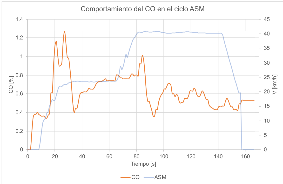
Figura A1. Comportamiento del CO en el ciclo ASM (prueba1).
