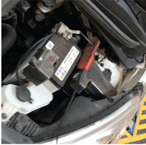
Figura 2.2 Pinza Trigger. (Fuente: propia)
