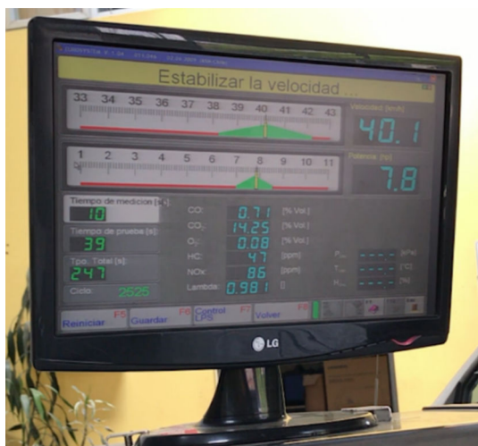
Figura 2.16 Fase de medición ASM 2525.
