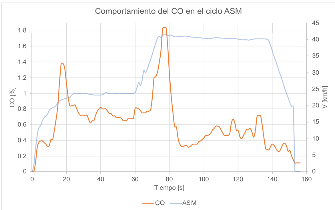
Figura A13. Comportamiento del CO en el ciclo ASM (prueba 5).
