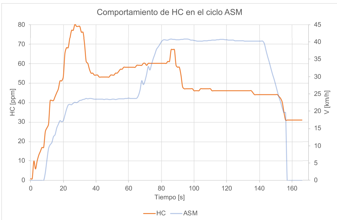
Figura A3. Comportamiento del HC en el ciclo ASM (prueba1).
