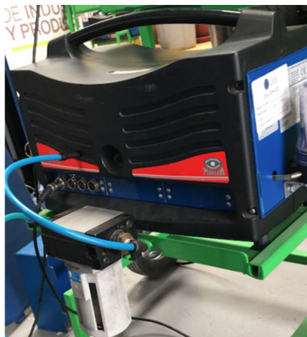
Figura 2.1 Analizador de gases MAHA MGT 5. (Fuente: propia)
