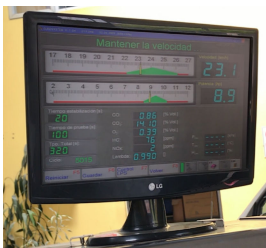
Figura 2.13 Fase de estabilización ASM 5015
