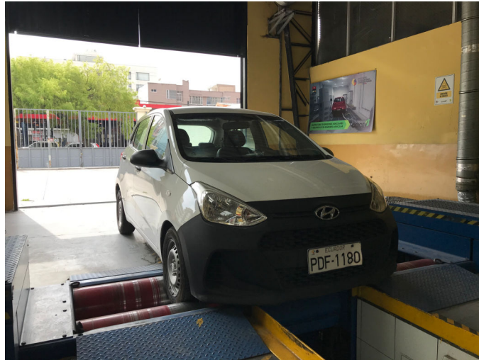
Figura 2.19 Automóvil sobre rodillos del equipo LPS 3000. (Fuente: propia)
