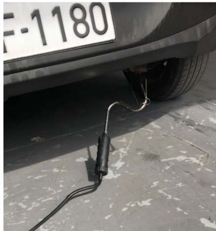
Figura 2.6 Sonda de gases de escape colocada. (Fuente: propia)
