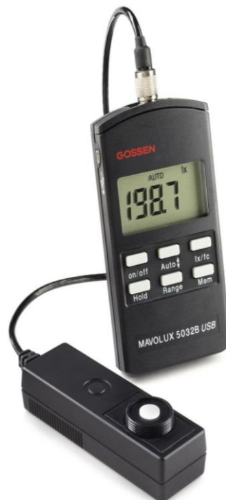
Figura 2.3. Luxómetro MAVOLUX 5032B
