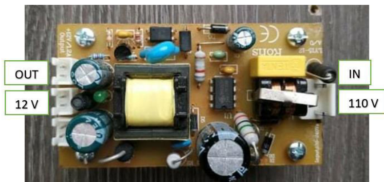
Figura 3.14 Fuente de alimentación principal
