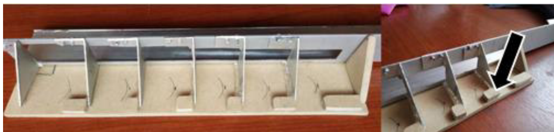
Figura 3.55 Barra clasificadora complementada con piezas de madera
