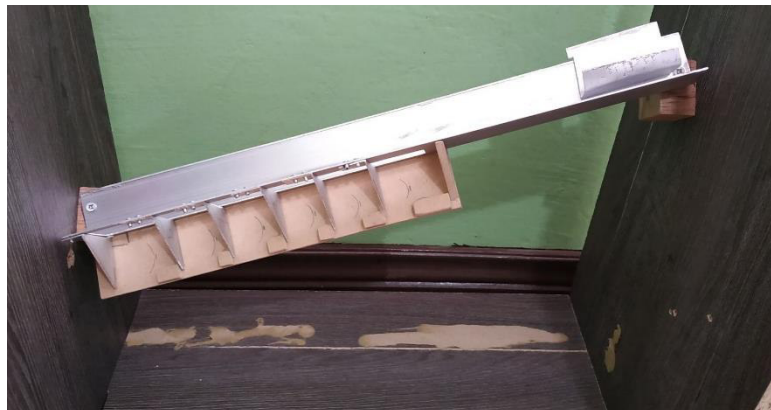
Figura 3.59 Resultado final de la implementación de la barra clasificadora con la base del prototipo
