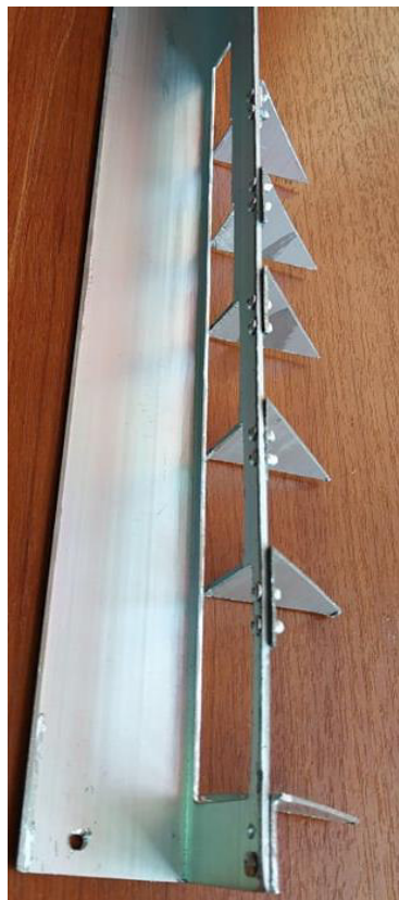
Figura 3.54 Barra clasificadora de monedas finalizada
