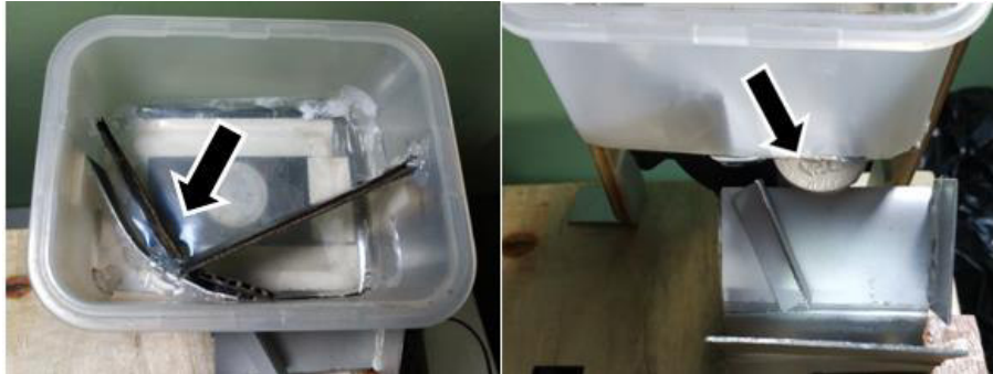
Figura 3.90 Implementación de orificio y piezas de conducción
