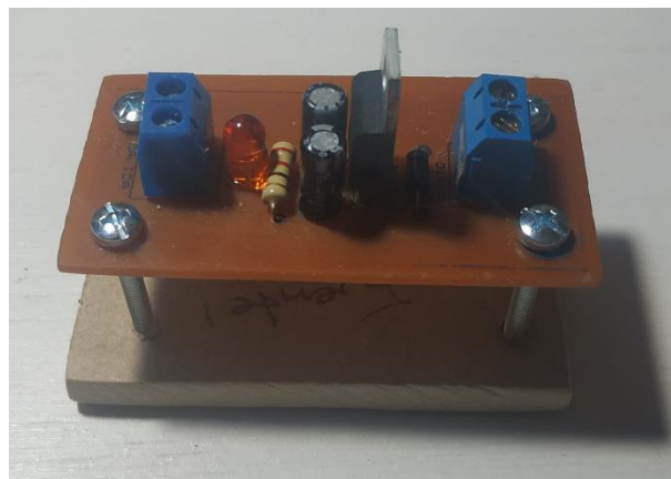
Figura 3.77 Placa PCB en base de madera
