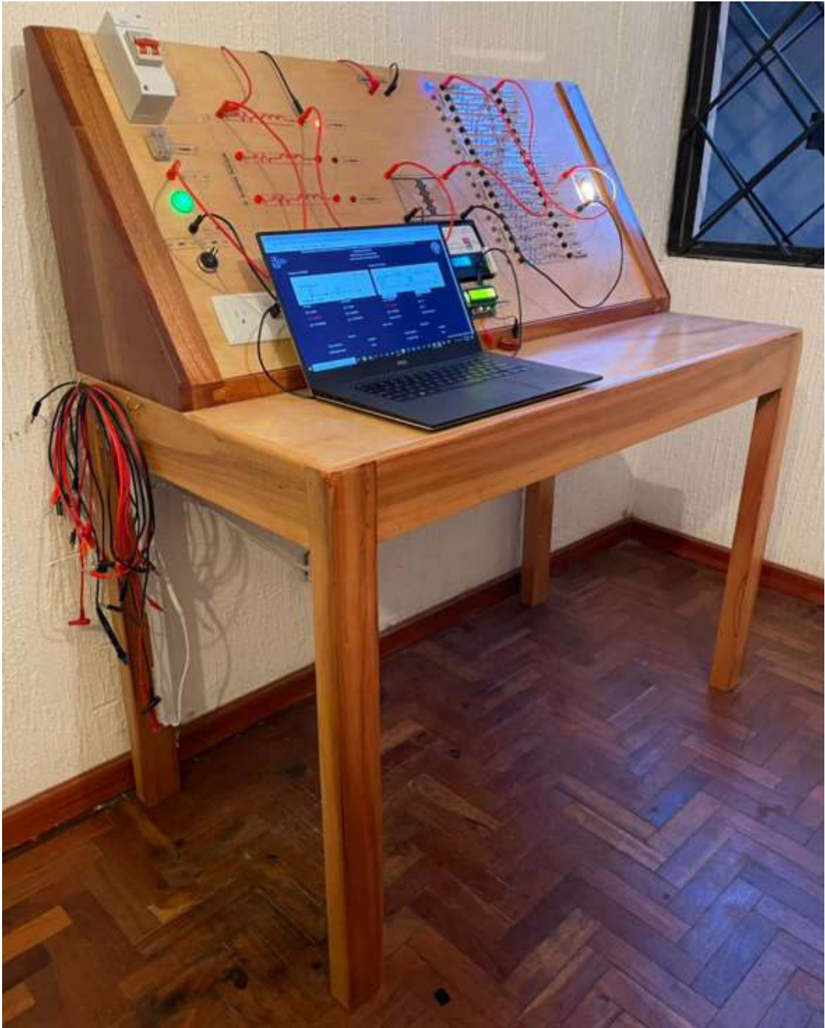
Figura V7. Módulo finalizado que representa el sistema de distribución de 13.8 kV.
