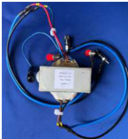
Figura 2.15. Núcleo acorazado en base a chapas tipo E utilizado en el prototipo.
