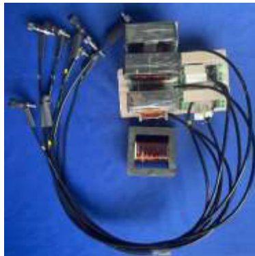
Figura 2.19. Inductancia construida en base a un núcleo acorazado de hierro.
