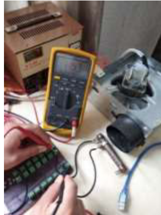
Figura 3.4. Medición de resistencia en medio voltaje a escala utilizando el multímetro Fluke 87V.
