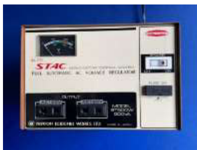
Figura 2.6. Regulador de voltaje automático a 120 V AC - 500 VA.
