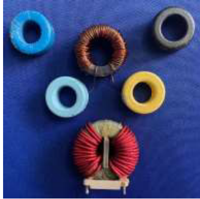
Figura 2.17. Inductancia construida en base a un núcleo toroidal.
