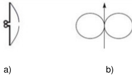
Figura 2.2 Parámetros para un dipolo de media onda. a) Distribución de corriente. b) Diagrama de radiación. [16]
