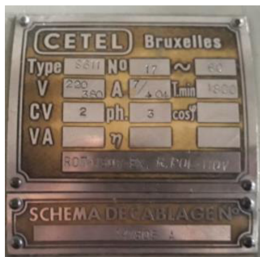
Figura 4.1 Datos de placa motor N°1 del laboratorio de Máquinas Eléctricas
