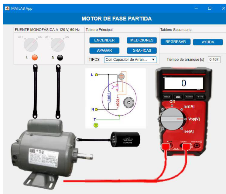
Figura 3.27 Interfaz de la práctica de motor fase partida con capacitor de arranque
