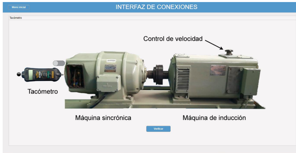
Figura 5.8. Ilustración del uso del tacómetro.
