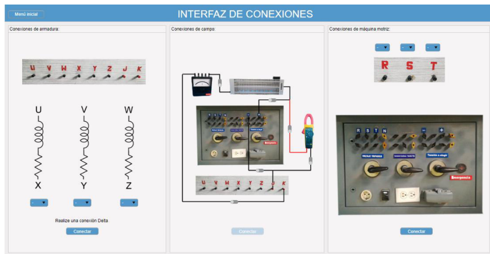
Figura 5.3. Conexión de circuito de campo, devanado de armadura y máquina motriz
