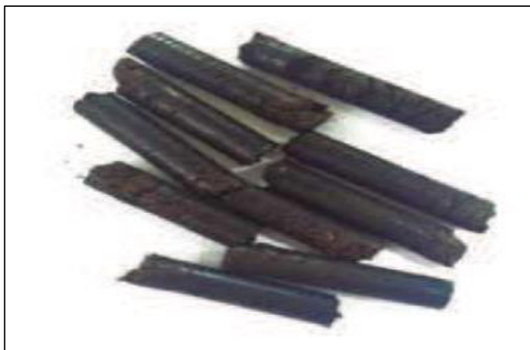
Figura 2.4. Pellets de biocarbón obtenidos a partir de raquis de palma (Talero et al., 2017a, p. 77)
