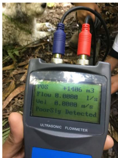
Figura 11. Medición de caudal con el caudalímetro ultrasónico
