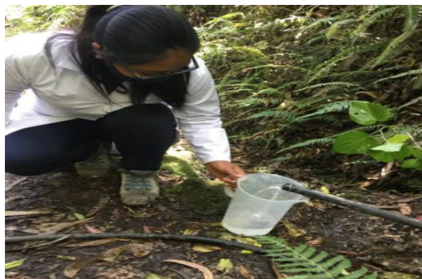
Figura 12. Aforo del caudal mediante el método volumétrico
