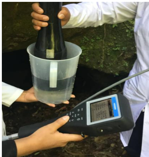
Figura 9. Medición in situ con el sensor multiparamétrico
