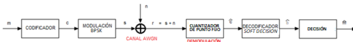
Figura 1.18. Sistema de comunicación a implementar con codificación, modulación BPSK, decodificación soft-decision sobre un canal AWGN
