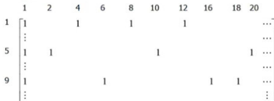
Figura 1.28. Parte de la estructura local en una matriz de verificación de paridad H
