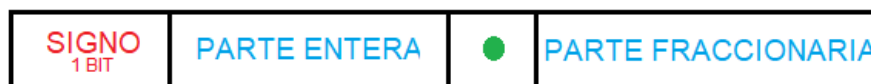
Figura 1.16. Representación de n bits para la cuantización con representación de arreglo de punto
