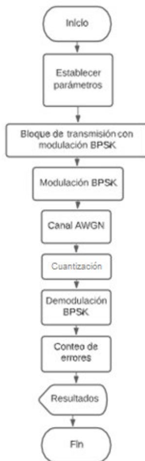
Figura 2.12. Pasos lógicos para la programación de un sistema de comunicación con modulación BPSK y cuantificación con representación de punto fijo sobre un canal AWGN
