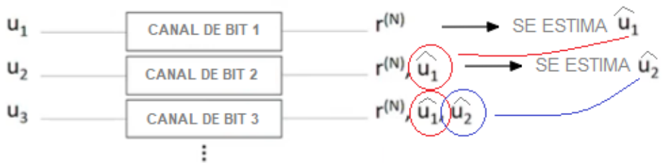
Figura 1.40. Decodificación basada en cancelación sucesiva por medio de la estimación de los bits u_i
