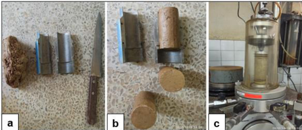
Figura 3.21 a) Preparación de muestra para el moldeado cilíndrico. b) Cilindros de suelo para el ensayo triaxial. c) Vástago que contiene el cilindro a ser ensayo juntamente con agua que ejerce una presión hidrostática constante.
