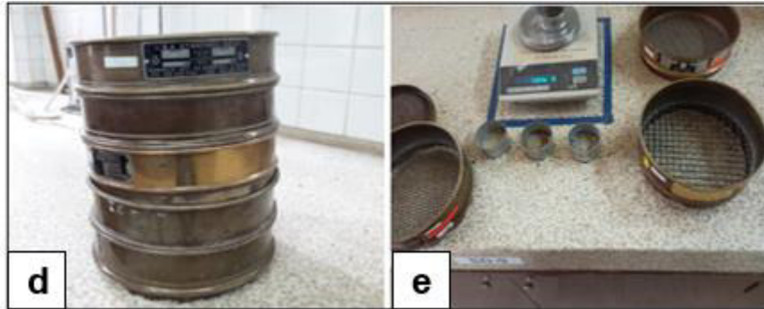
Figura 3.10: a) Lavado de la muestra de suelo. b) Pesaje y etiquetado de la cápsula vacía. c) Muestra recogida del tamiz N°200. d) Tamices ordenados de mayor a menor abertura. e) Pesaje del material retenido por cada uno de los tamices.
