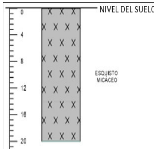
Figura 3.7: Esquema litológico sondeo SPT 5.
