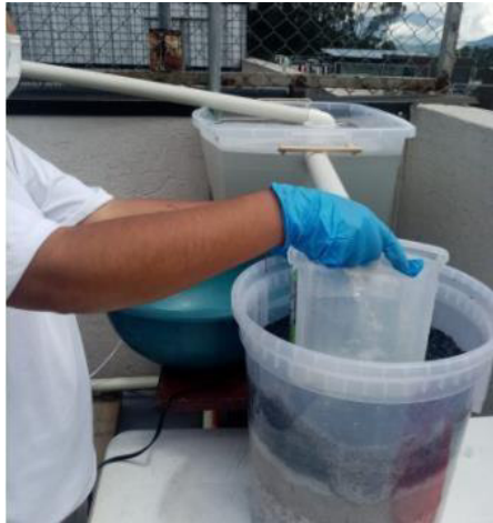
Figura 10: Toma de muestras del efluente de la trampa de grasas
