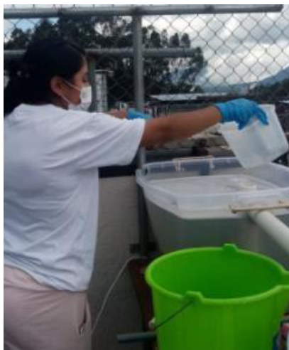
Figura 9: Toma de muestras del efluente del lavador
