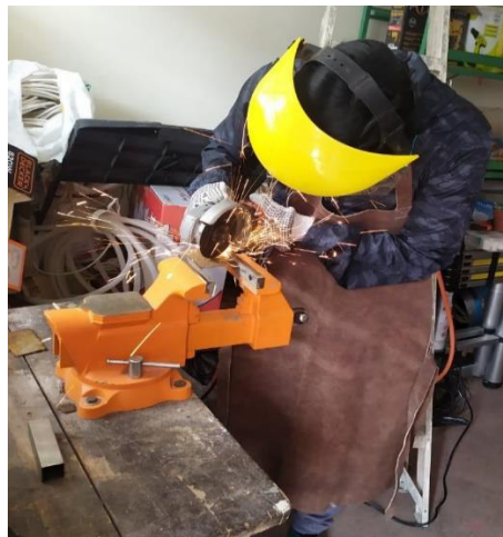
Figura 2.50. Corte de tubos cuadrados.
