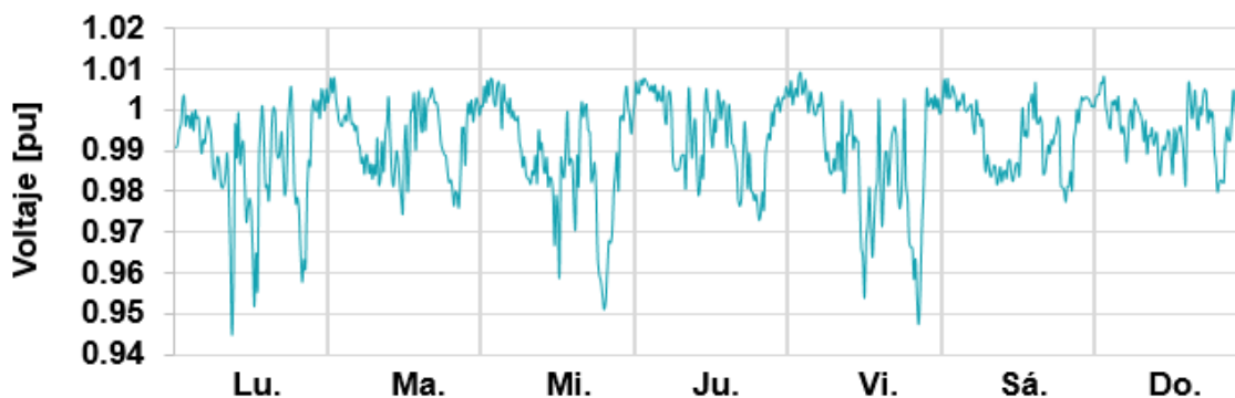
Figura 7.14. Voltaje en la barra 312 sin GD conectada
